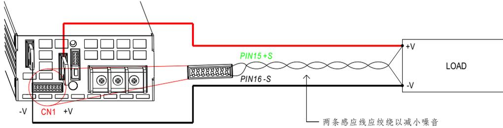
◎ +S 信号应连接负载的正极, -S 信号应连接负载的负极
