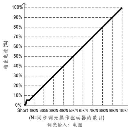
注意: 1. 最小的调光比例在 8%左右, 当输出电流在  $0% < I_{out} < 8%$  时, 输出电流精度不做定义。
